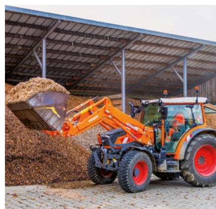
Mit der Leichtgutschaufel wird dem Hackschnitzellager das Material entnommen und anschließend der Behälter der Heizanlage aufgefüllt. Im Fahrzeug: Stefan Höfle.
