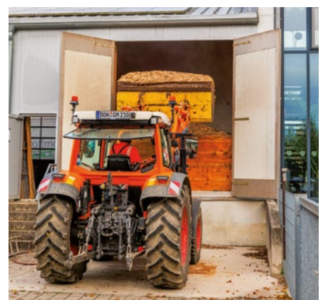
Mit der Leichtgutschaufel wird dem Hackschnitzellager das Material entnommen und anschließend der Behälter der Heizanlage aufgefüllt. Im Fahrzeug: Stefan Höfle.
