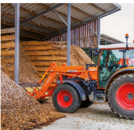
Mit der Leichtgutschaufel wird dem Hackschnitzellager das Material entnommen und anschließend der Behälter der Heizanlage aufgefüllt. Im Fahrzeug: Stefan Höfle.
